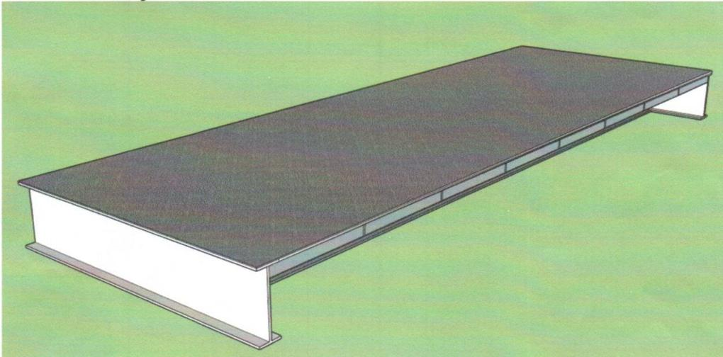
A mesma será composta por perfis em vigas I e vigas T com chapas de aço  $\frac{3}{4}$ ", com as dimensões conforme projeto.
